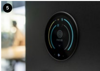
5 Hushassistant Les utilisateurs peuvent ajuster en quelques secondes des paramètres comme la lumière et la ventilation, créant ainsi un espace adapté à leurs besoins (en option).
